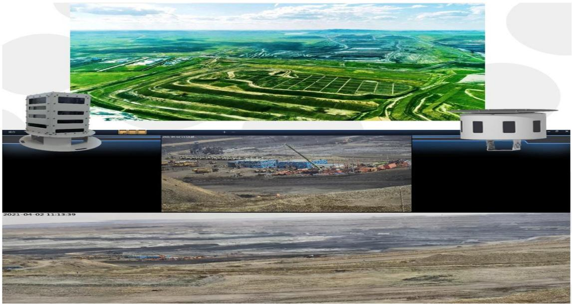
在露天矿开采作业区和排土场分别架设 4.3 亿像素水平视场角  $120^{\circ}$ ，垂直视场角  $30^{\circ}$  和 1 亿像素水平视场角  $180^{\circ}$ ，垂直视场角  $80^{\circ}$  的亿像素复眼全景摄像机各一台，对矿区和排土场进行全场景拍摄。
