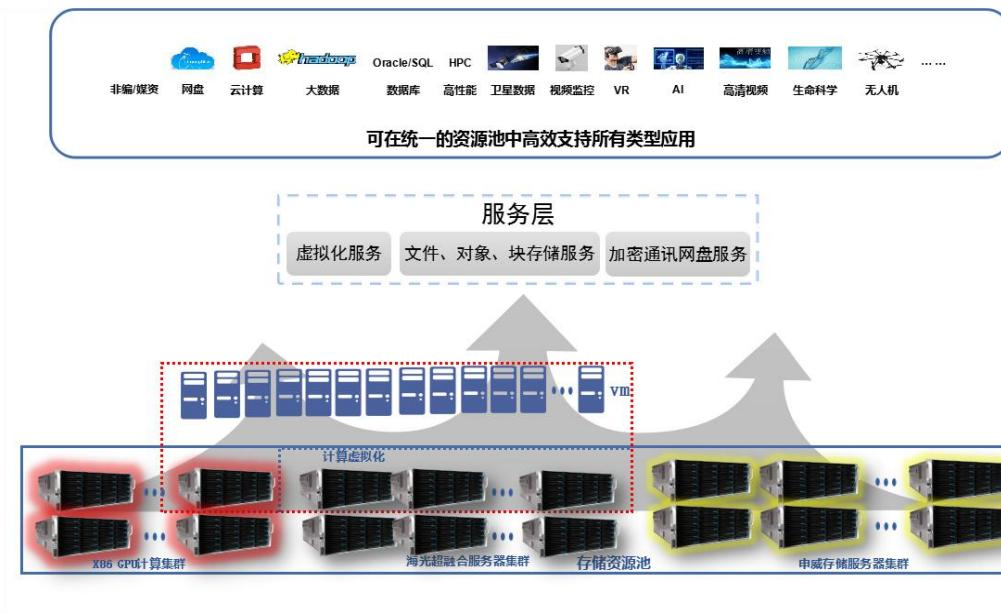
J 级系统采用海光/鲲鹏服务器集群提供虚拟化服务，x86 GPU 集群提供 GPU 计算资源，整合海光/鲲鹏集群、申威集群、x86 集群上的硬盘资源构建统一存储资源池，为虚拟化服务及 GPU 计算资源提供高安全、高性能的存储服务。
