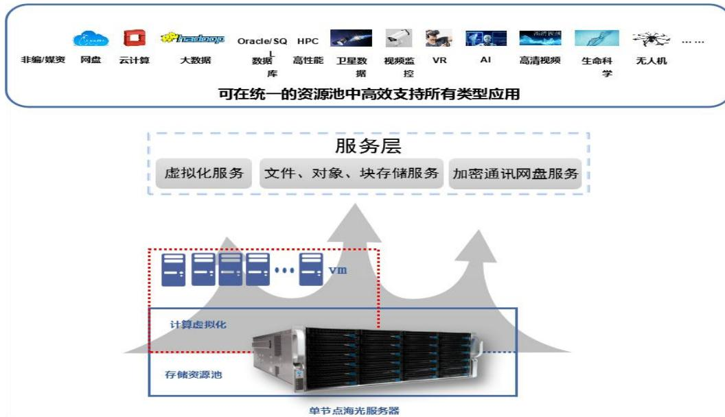
Y 级系统采用单台海光/鲲鹏节点提供虚拟化、存储+加密通讯网盘服务，主要为 Y 级单位提供小规模共享、虚拟化资源提供支持，并且可以支持内网加密通讯网盘，实现 Y 级内部交流互通，数据安全存储的目的。
