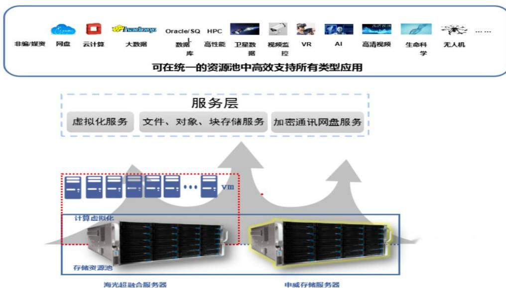
LV 级架构图可得知，为保障数据安全可靠的同时，还需提供更高效的虚拟化资源，采用 1 台海光/鲲鹏节点+1 台申威节点组成集群。由海光/鲲鹏节点提供计算虚拟化服务，由海光/鲲鹏和申威节点异构混合构建统一存储池，共同为上层业务提供存储服务，满足虚拟化服务的存储需求，也保障数据安全可靠。
