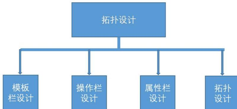
模板栏设计模块主要物理设备栏、虚拟路由交换栏、虚拟网关栏和终端栏；操作栏包含拓扑设计的各种操作；属性栏包含设备属性，支持设置设备属性；拓扑设计支持通过拖拽方式可视化地搭建网络拓扑。
