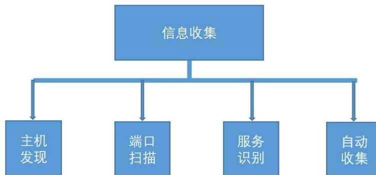
主机发现模块，能够发现某个网段内所有主机，在输入框中，输入需要查询的网段信息，格式如：192.168.10.0/24，点击执行。
