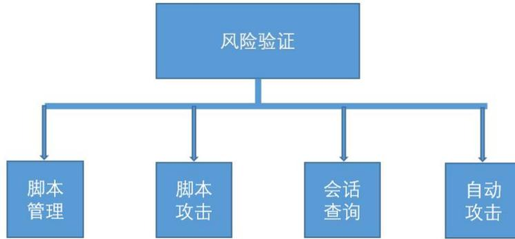
系统通过快速风险验证功能提供针对网络节点上发现的漏洞进行验证或发起攻击的能力。快速风险验证能够跟网络节点详细信息展示相关联，查看网络节点详细信息中的漏洞后调出快速风险验证功能，用户配置风险验证相关参数后就能快速进行风险验证或利用，快速风险验证参数设置包括但不限于风险验证、攻击的插件选择、目标网络节点 IP 地址、目标端口、有效载荷代码选择等。
