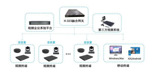
如图所示为本次项目建设系统采用最先进的视频会议技术,同时充分考虑用户现有网状况,建设一套符合用户需求的视频会议系统,平台支持第三方视频会议终端接入,会议室采用分体式硬件终端部署,同时支持 PC 和手机接入。
